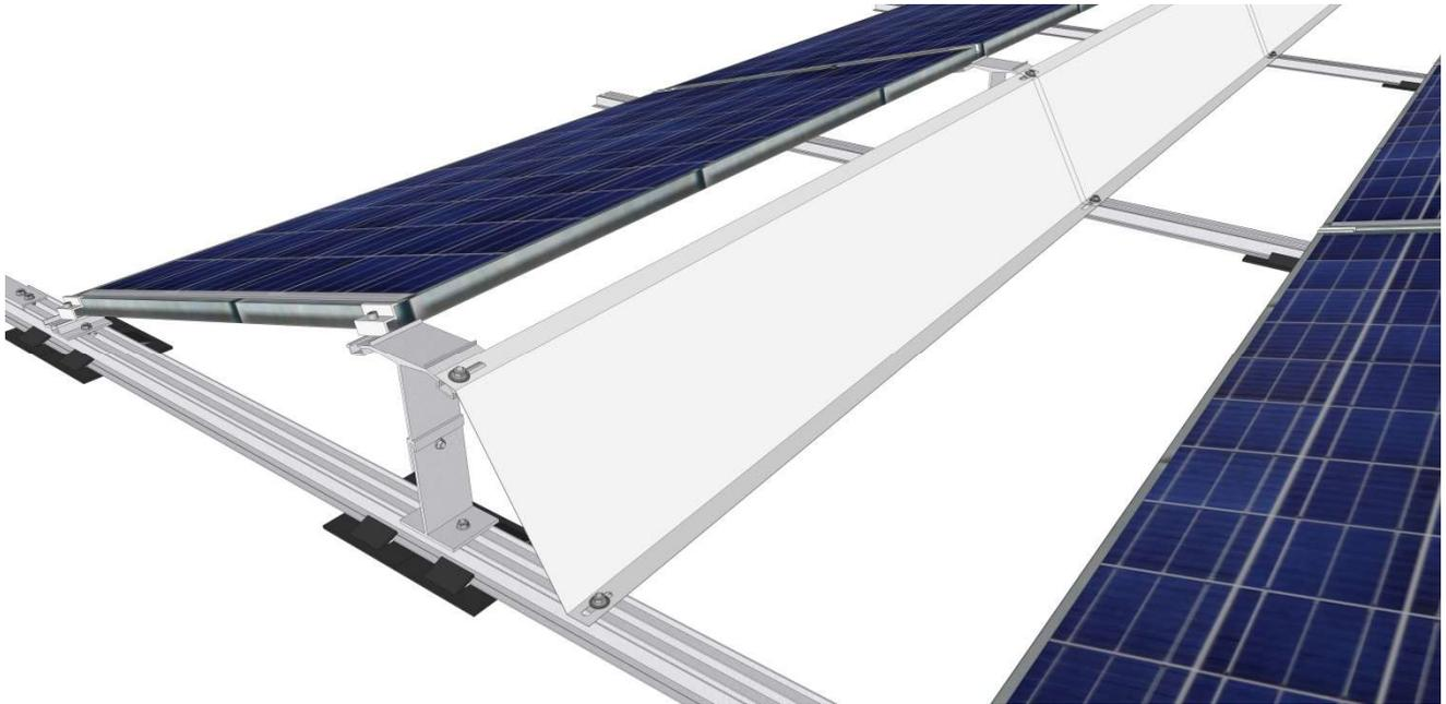
Die Befestigung erfolgt mittels Hammerkopfschraube M8x20 (Art. Nr. 21922), Unterlegscheibe 8,4x25 (Art. Nr. 21909) und Sperrzahnmutter (Art. Nr. 21915)
